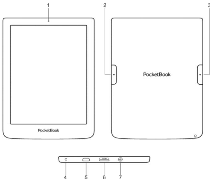
1. **Датчик освещенности** — позволяет экранной подсветке адаптироваться к окружающему освещению;
